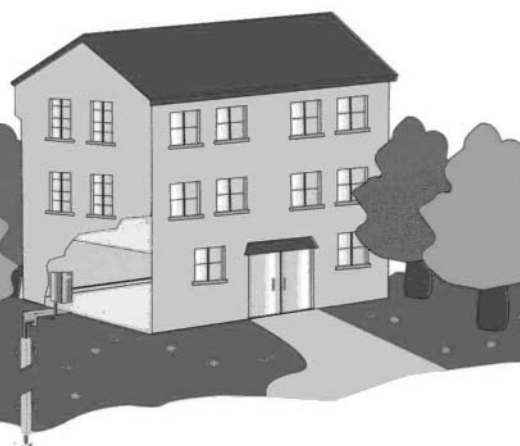
Capteurs verticaux dans le sol
